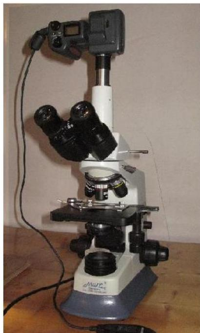
Les photographies à fort grossissement ont été réalisées à l'aide d'un microscope trinoculaire et d'un Coolpix 995 Nikon muni d'un adaptateur et d'un déclencheur électrique.
